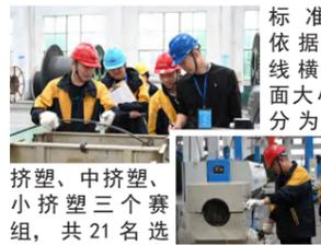
挤塑、中挤塑、小挤塑三个赛组,共21名选手参赛。组装机头、调整参数、调试设备……导体穿过机头,覆盖上绝缘(护套)层,参赛选手通过设备上的显示屏,观察绝缘层的包裹情况,并随时变更指令进行微调。由于设
