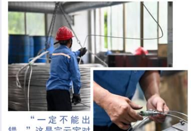
“一定不能出错。”这是宗云宝对自己的要求。排线整齐杜绝抽丝，避免下道工序断丝多；拉丝过程要勤测量单丝直径，单丝控制在工艺范围内；检查控制的单丝有无毛刺，如果出现毛刺，分析是原材料还是设备问题造成，单丝表面要光滑；拉出来的单丝在流转过程中不能有沾灰，更不能有磕碰伤。
